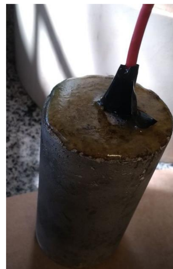
Figura 2: Amostra pronta para imersão.
